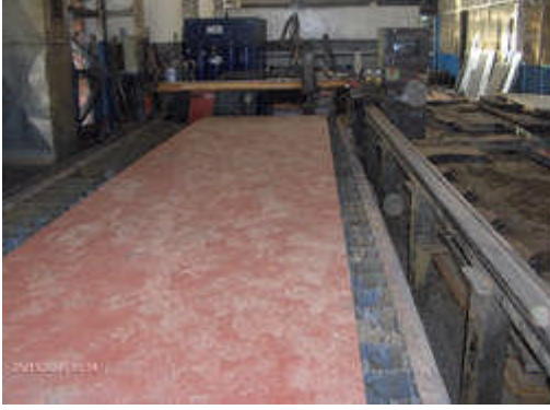
Resim 1.16-17: Lazerle milimetrik kesim yapabilen CNC tezgâh
