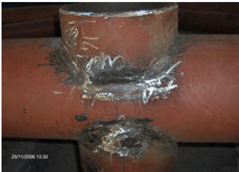
Resim 1.32-33: Taşlama kontrolü yapılmış çelik malzeme
