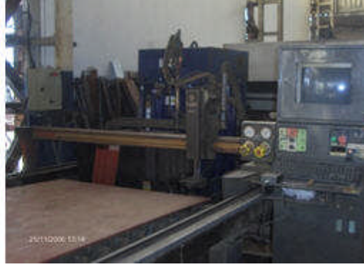
Resim 1.16-17: Lazerle milimetrik kesim yapabilen CNC tezgâh
