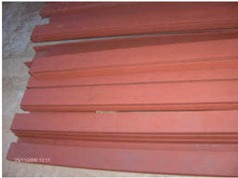
Resim 1.12-13: Astarlamadan çıkmış, astar kalınlığı kontrol edilmiş malzeme
