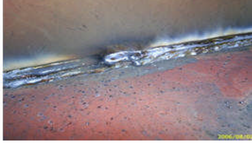
Resim 1.29 : Kat kat düzgün olmayan dağılım
