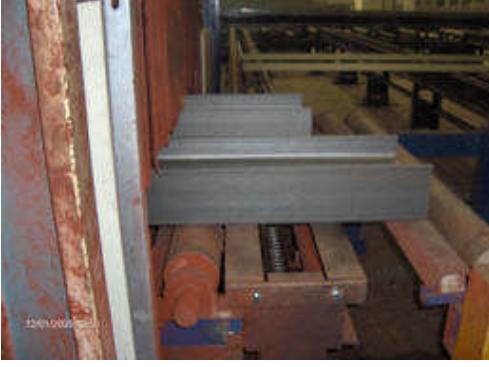
Resim 1.8-9: Kumlama ünitesinden çıkan malzeme
