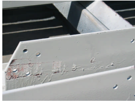
Resim 1.45-46: Kalın vurulan boya ve kurumadan yapılan istiflemeyen kaynaklanan hatalar
