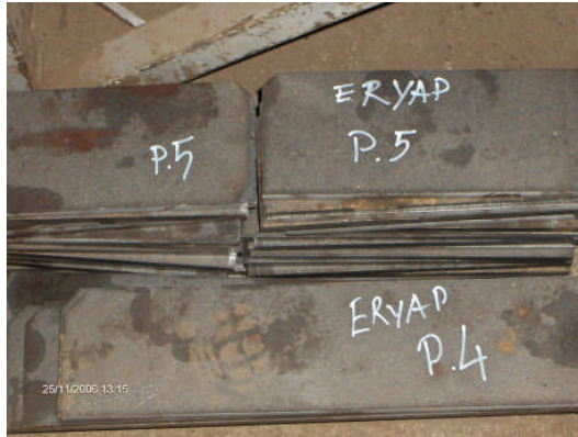
Resim 1.19: Giyotin makinesiyle kesilmiş levhaların kesimi
