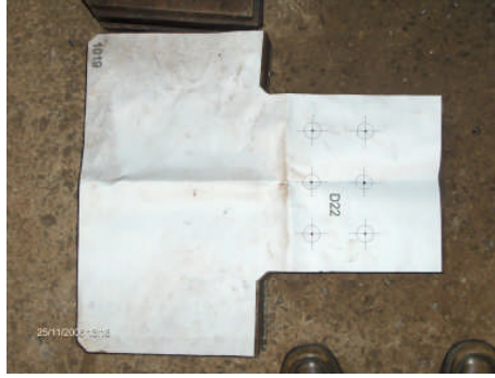
Resim 1.20: Projeye göre hazırlanmış delik şablonu
