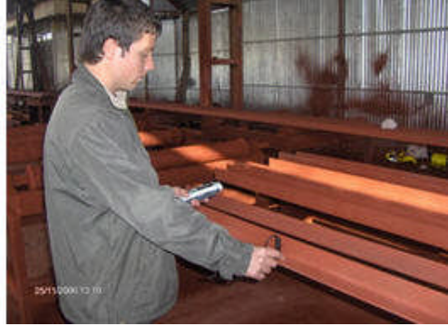
Resim 1.10-11: Malzemenin astar kalınlığı mikrometre ile kontrol edilmesi
