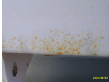
Resim 1.39-40: Boyanın kurumadan yağmur veya neme maruz kalması sonucu oluşan korozyon
