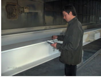
Resim 1.37-38: Mikrometre ile boya film tabakasının kalınlığının kontrol edilmesi
