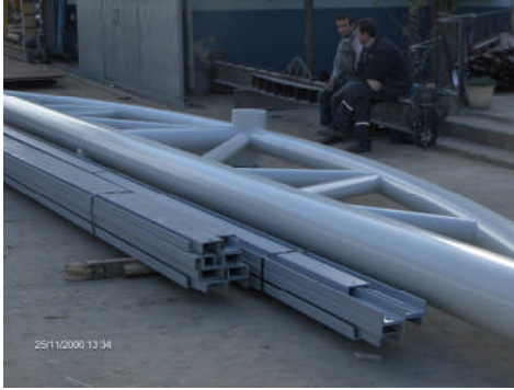
Resim 1.53-54: Gruplandırılarak istiflenmiş nakliyeyle hazır hale getirilen çelik malzemeler
