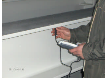
Resim 1.37-38: Mikrometre ile boya film tabakasının kalınlığının kontrol edilmesi
