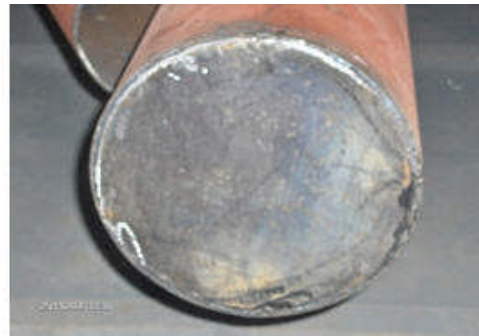
Resim 1.32-33: Taşlama kontrolü yapılmış çelik malzeme
