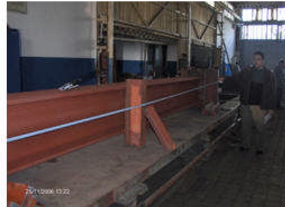
Resim 1.23-24: Kalıbın ölçülerinin ve gönyesinin doğruluğunun imalat kontrol elemanı tarafından kontrol edilmesi
