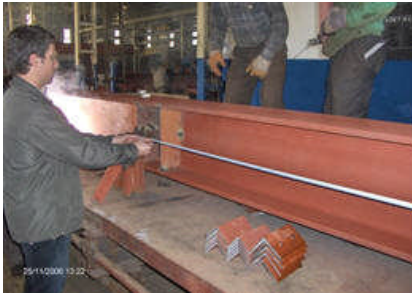
Resim 1.23-24: Kalıbın ölçülerinin ve gönyesinin doğruluğunun imalat kontrol elemanı tarafından kontrol edilmesi
