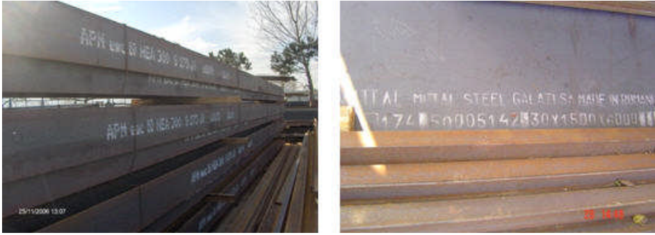
Resim 1.2, Resim 1.3: Düzgün istif edilmiş ve üzerinde özellikleri yazılmış çelik malzeme
