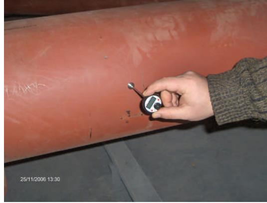
Resim 1.34: Boya için malzemenin sıcaklığının ölçülmesi
