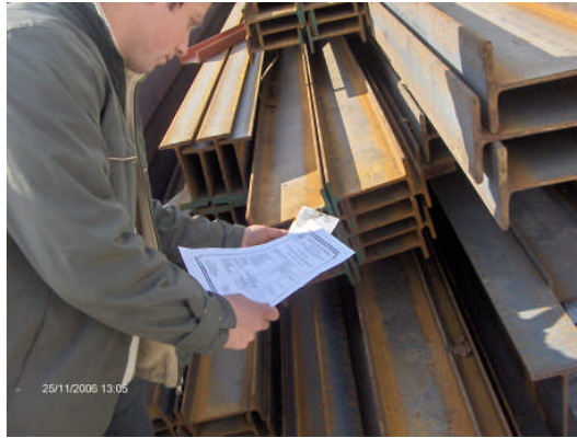
Resim 1.7: Malzemenin sipariş formuyla etiket bilgilerinin karşılaştırılması
