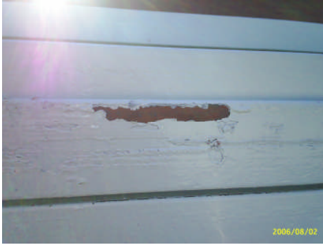
Resim 1.47-48: Yüzey temizliği iyi yapılmamış malzeme
