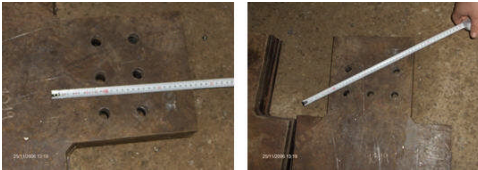
Resim 1.21-22: Delik çaplarının ve akslarının doğruluğunun kontrolü
