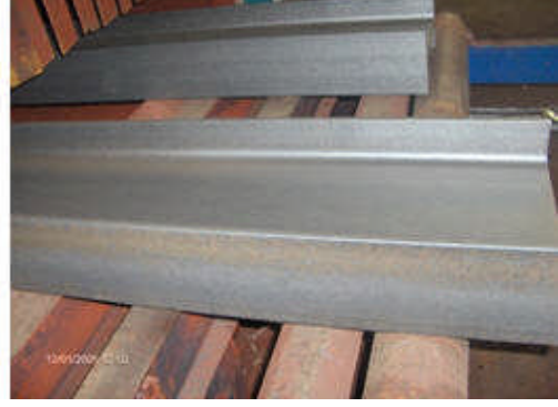
Resim 1.8-9: Kumlama ünitesinden çıkan malzeme
